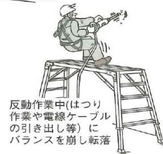
反動作業中(はつり作業や電線ケーブルの引き出し等)にバランスを崩し転落
