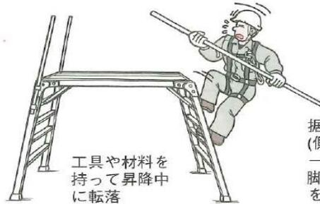
据え付け場所が悪かった(側溝、穴、養生中のスリーループ等の近くや上部)ため脚が落ち込み、バランスを崩し転落
