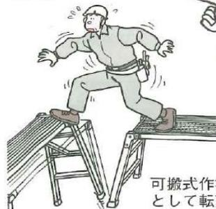
可搬式作業台へ飛び移ろうとして転落
