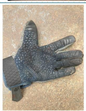
使用していた手袋（耐切創手袋ではない）（写真は被災していない左手の手袋）
