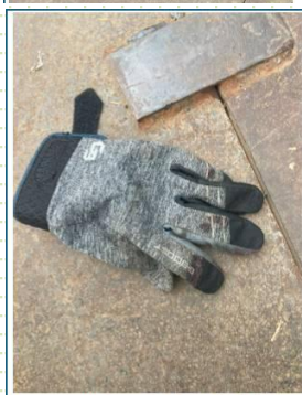
使用していた手袋（耐切創手袋ではない）（写真は被災していない左手の手袋）
